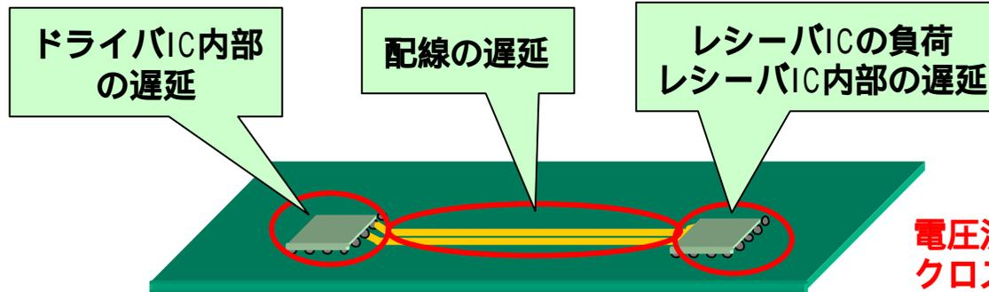
電圧波形の反射、遅延、オーバーシュート、クロストークの低減設計
